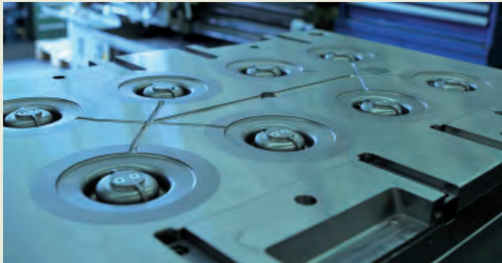
Wieder ein Stück Massarbeit erledigt: Die Form ist fertig.
