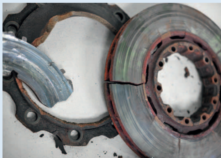
Defekte Bremsscheiben – kein Durchkommen im SVZ.
